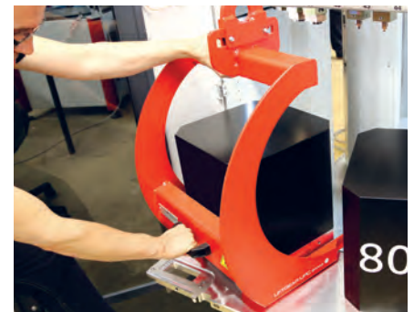
Die ausziehbaren Magazinebenen sind auch praktisch für das Beladen des Magazins mit EROWA Lift oder Deckenkran direkt auf die Magazinposition.
