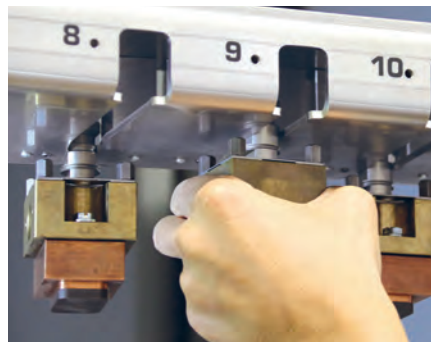
Die Durchreiche; die neue und geniale Lösung zur Magazinbeladung mit Elektrodenhaltern. Bequem werden die Halter von der Bedienerseite des Magazins herein- und ausgewechselt.
