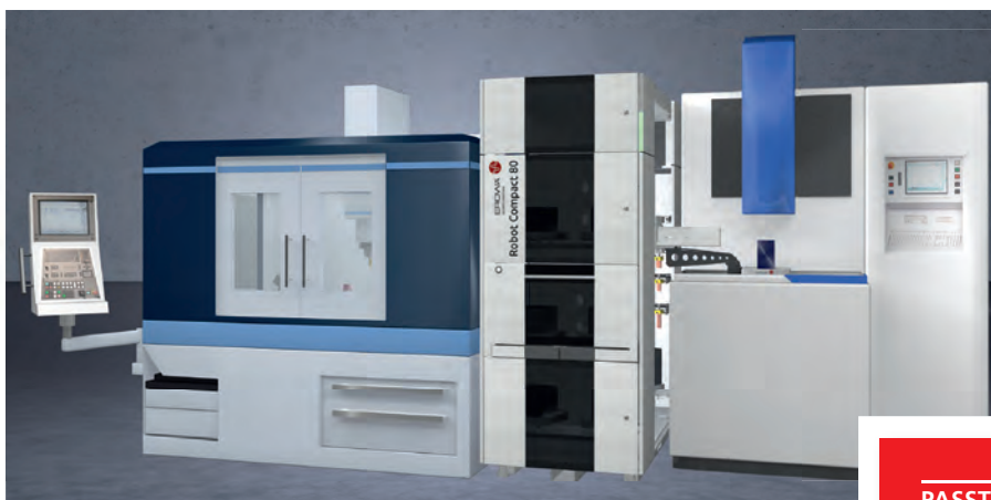
EROWA Robot Compact zwischen einer Senkerodiermaschine und einem Fräscnter.
