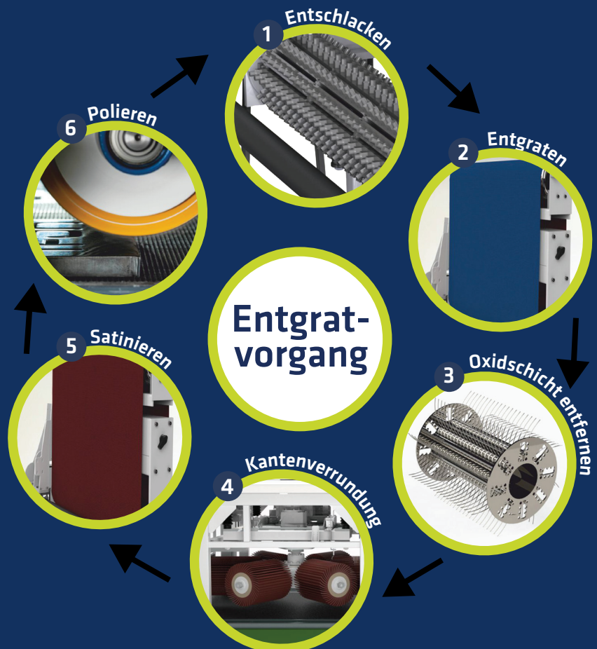
Beispiel Modulaufbau mit 3 Modulen: 2 Entgraten, 4 Kantenverrunden und 5 Satinieren.
