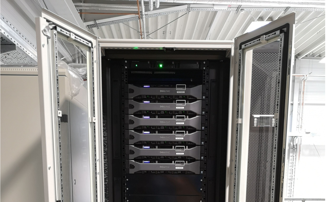
BU: Einblick auf den sechs Knoten Edge Computing Cluster in der Maschinenhalle am WZL-Standort Rotter Bruch © WZL / Feuerhack
