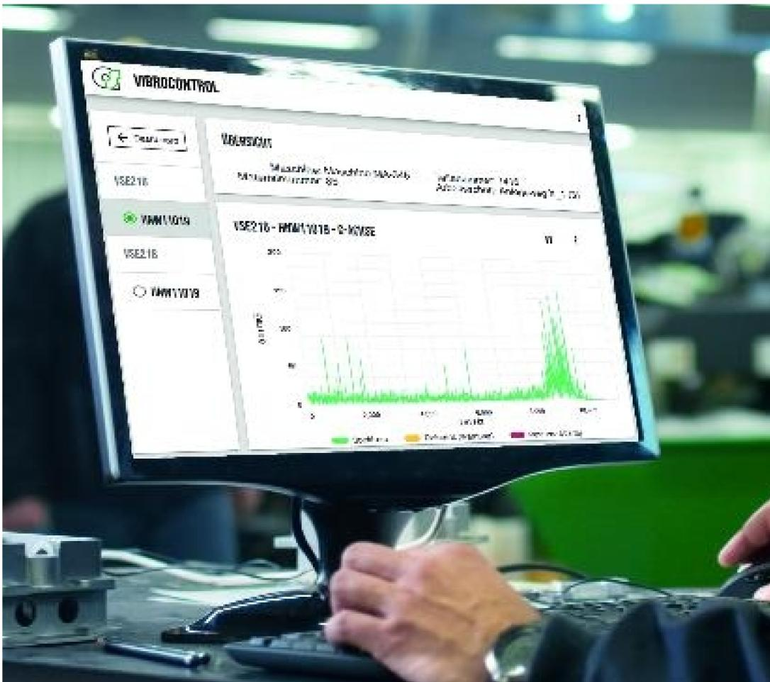
VibroControl ist ein innovatives Frühwarnsystem für Produktionsprozesse in der spanenden Fertigung. Mit dieser Prozessüberwachung realisieren Betreiber beispielsweise eine bessere Ausnutzung der Werkzeugstandzeiten, verringern den Ausschuss und die Stillstandzeiten.
