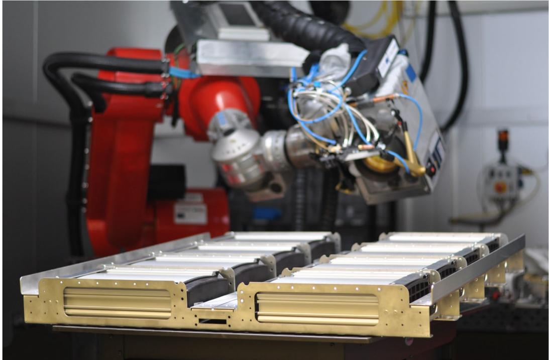
Vorrichtungslos lasergeschweißtes Low-Cost Batteriepackgehäuse aus hochfestem Aluminium (© WZL)
