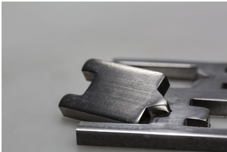
Schnittteil des Versuchsprozesses mit diversen Geometrieelementen (© WZL)
