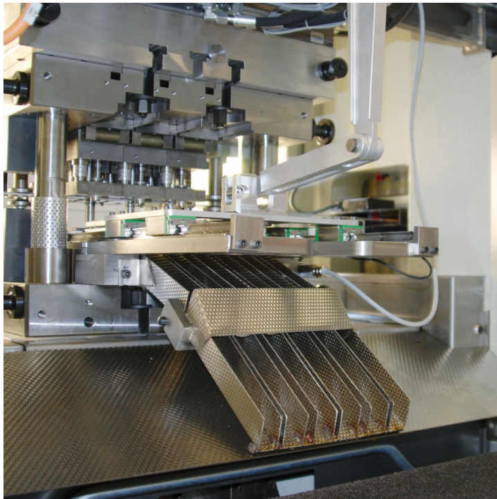
Feinschneidwerkzeug mit servomechanischem Ausräumersystem (© Feintool Technologie AG)
