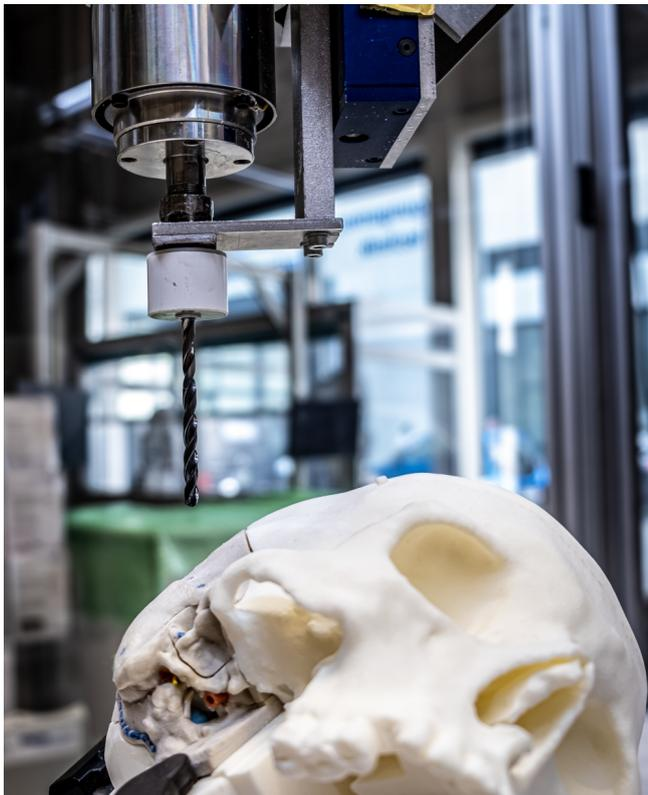
Sensorgestütztes Konzept soll thermische Schädigungen des Gewebes während des Bohrprozesses vermeiden (© WZL)
