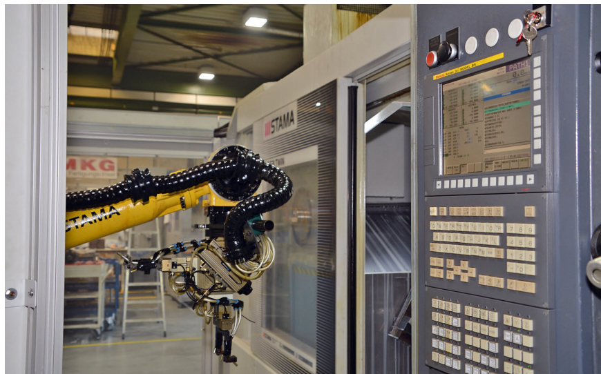
5 Ergänzt um einen Belade- und Entladeroboter kann das Bearbeitungszentrum MC 531 TWIN der Marke Stama mehrschichtig bedienerlos fertigen © Hanser
