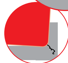
Herkömmliche WSP Ausbrüche und Absplitterungen an schmalen Stegen.
