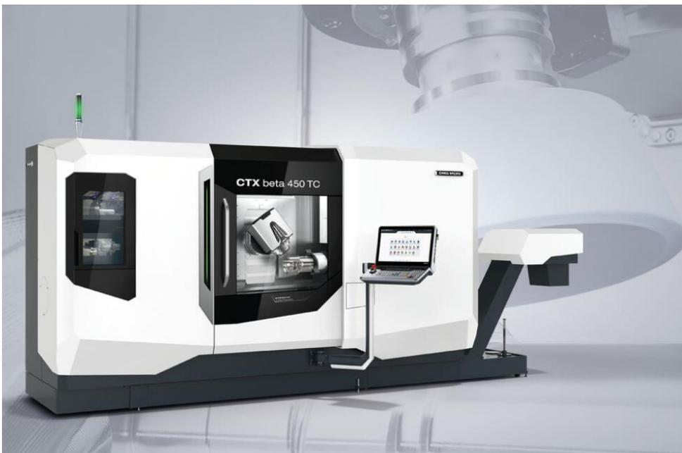
*Mit lediglich 10 m<sup>2</sup> Aufstellfläche markiert die CTX beta 450 TC den neuen Einstieg in die Baureihe der Hightech-Dreh-Fräszentren von DMG MORI.*
